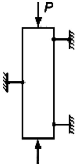
Рисунок 13 - Схемы закрепления стоек при испытании
