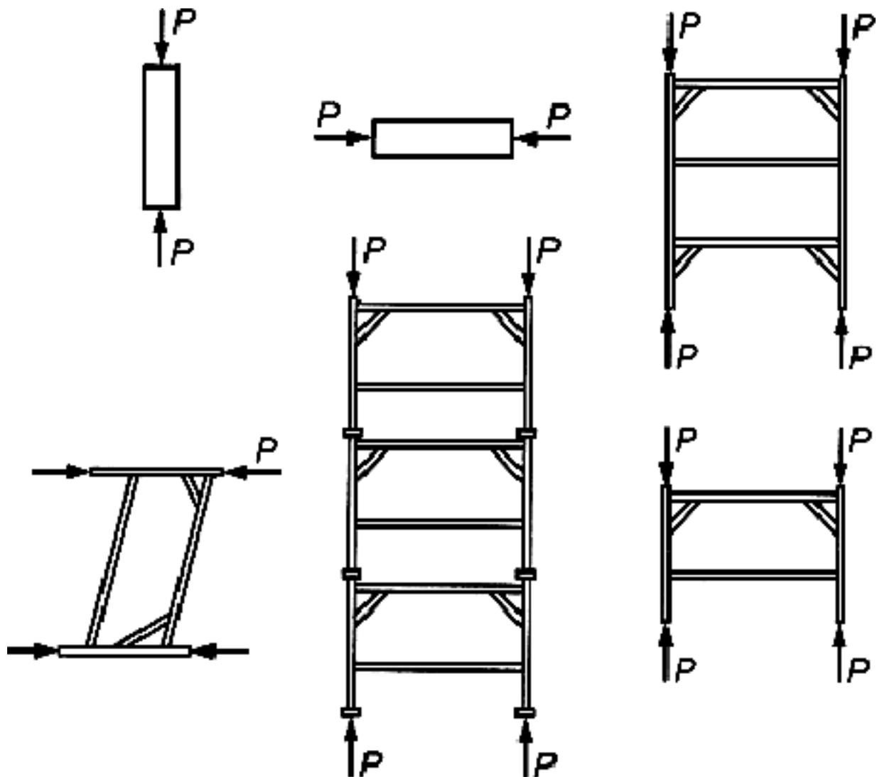
Рисунок 12 - Схемы испытания рам
