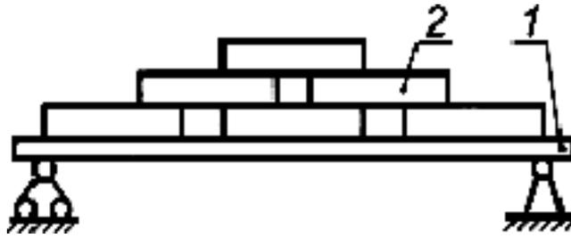
1 - испытательный образец; 2 - штучные грузы
