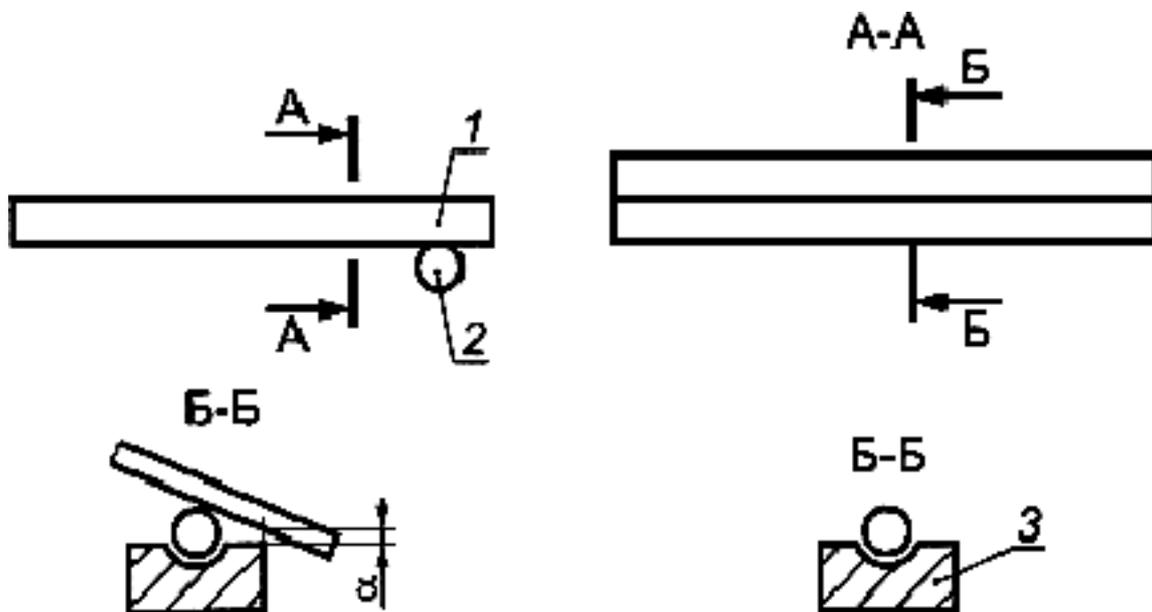
1 - щит; 2 - опора; 3 - седло опоры;  $\delta$  - зазор между щитом и седлом опоры
