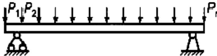
Рисунок 8 - Схема нагружения множеством  $P_1, P_2, \dots, P_n$  сосредоточенных нагрузок
